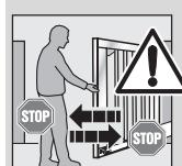
Należy poinstruować wszystkie osoby korzystające z bramy, w jaki sposób prawidłowo i bezpiecznie obsługiwać bramę. Prosimy zademonstrować i przetestować działanie rozryglowania mechanicznego oraz cofanie z przyczyn bezpieczeństwa. W tym celu należy przytrzymać zamkającą się bramę obiema rękoma. Zgodnie z zasadami bezpieczeństwa brama powinna się zacząć cofać.
