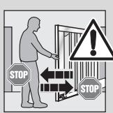
Zaškolte všetky osoby, ktoré bránu používajú, v správnej a bezpečnej obsluhe. Demonštrujte a otestujte mechanické odblokovanie, ako aj bezpečnostný spätný chod. Za týmto účelom zadržte bránu počas jej posunu obidvoma rukami. Zariadenie brány musí spustiť bezpečnostný spätný chod.
