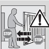
Visas personas, kas lieto vārtu mehānismu, ir jāinstruē par drošu ekspluatāciju saskaņā ar priekšrakstiem. Demonstrējot pārbaudiet mehānisko atbloķēšanas mehānismu un vārtu drošības atpakaļgaitu. Vārtu aizvēršanās laikā pieturiet tos ar abām rokām. Vārtu mehānismam ir jāievada vārtu drošības atpakaļgājiens.
